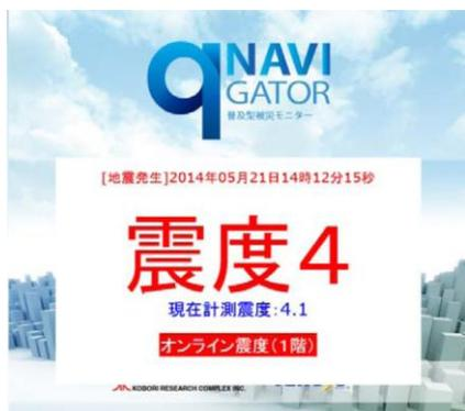
発災時画面（設置ビルにおける計測震度を表示）
